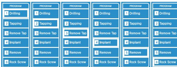
Über diese Taste kann der Bediener ein geeignetes Programm für den Eingriff auswählen. Das Programm durchläuft die Stufen 1 bis 6, wenn die Programmtaste gedrückt wird. Es wechselt von Drilling (Bohren) → Tapping (Gewinde bohren) → Remove Tap (Gewindeschneider entfernen) → Implant (Einsetzen) → Remove (Entfernen) → Rock Screw (Schraube hin- und herbewegen). Eine weiße Umrandung zeigt an, welches Programm ausgewählt wurde.
