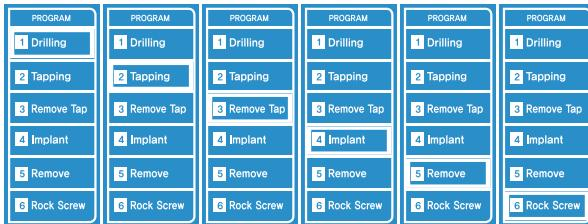
Een gebruiker selecteert met deze knop een programma dat nodig is voor een operatie. De programma's gaan van cijfers 1 tot 6 teltens als u op de programmaknop drukt. Dit wijzigt de volgorde van Boren->Kloppen->Klop verwijderen->Implantaat->Verwijderen ->Steenschroef. Een witte rand geeft het geselecteerde programma aan.
